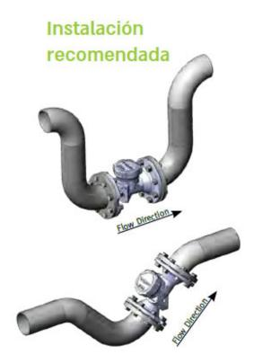
El montaje del equipo aguas abajo de cualquier componente hidráulico (válvula, bomba) debe cumplir una distancia mínima de cuatro (4) diámetros de tubería.
